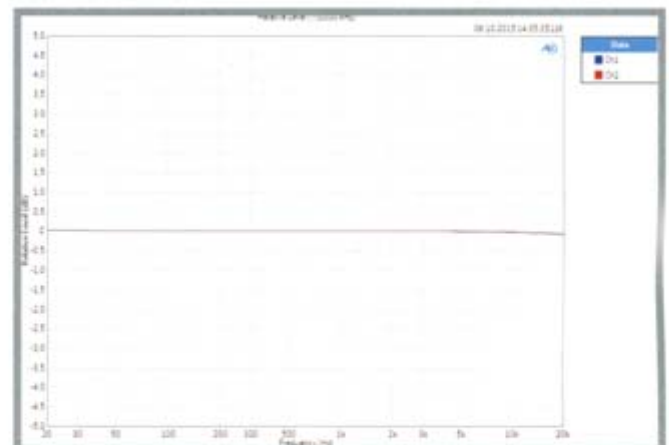
Der Frequenzverlauf ist schnurgerade. Abweichungen sind kaum sichtbar, im hörbaren Bereich schon gar nicht
