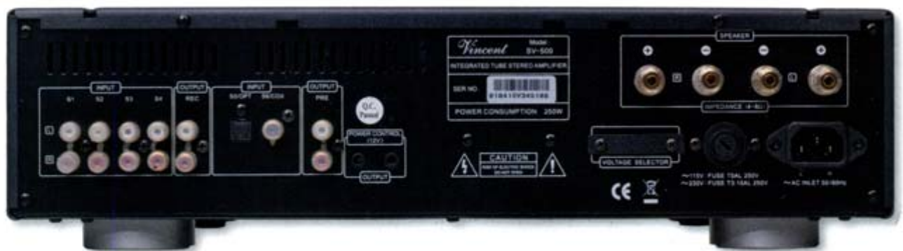
An den Vincent SV-500 lassen sich vier analoge und zwei digitale Zuspierer anschließen. Dazu gibt es einen Audio-Ausgang, über den etwa eine Tonbandmaschine Signale zum Aufnehmen entgegen nimmt
