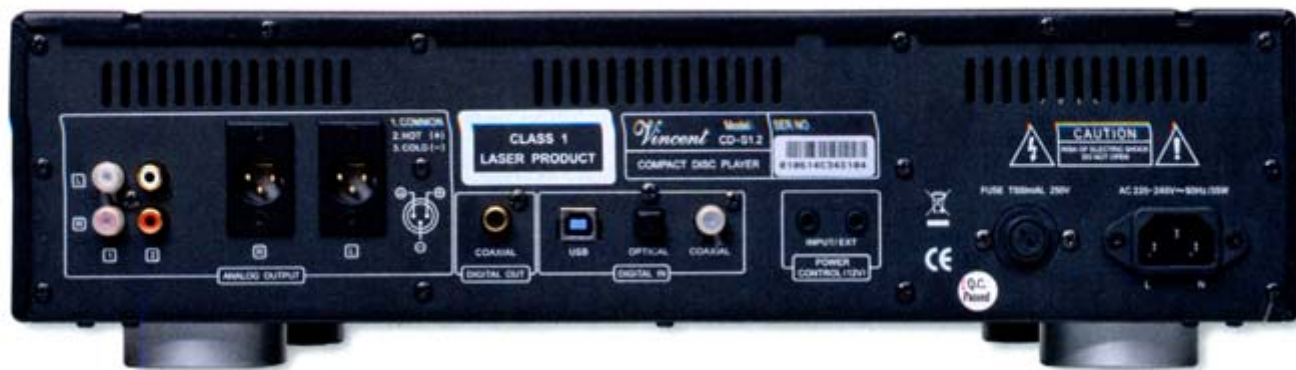
Die Rückseite des Vincent CD-S1.2 beherbergt neben Ausgängen in Cinch- und XLR-Ausführung auch mehrere Digitaleingänge, über die externe Audioquellen vom D/A-Wandler des Players profitieren
