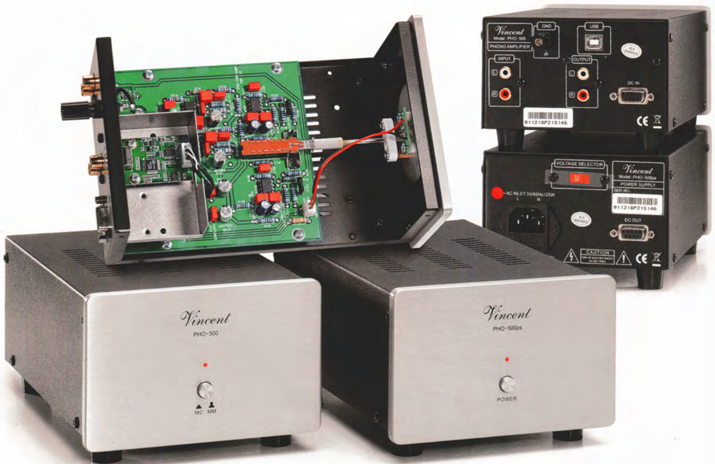
Phonoververstärker Vincent PHO-500 mit separatem Netzteil PHO-500ps. Integrierter Analog/Digital-Wandler zur Überspielung und Digitalisierung per USB. Die DIP-Schalter zur Anpassung von Kapazität und Abschlusswiderstand des Tonabnehmers befinden sich auf der Unterseite des Phonomoduls
